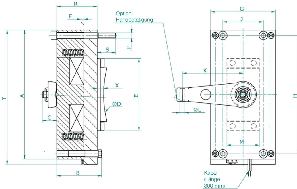
Toleranzen bei der Versorgungsspannung an den Bremsklemmen = 5 % / - 10 % (NFC 79-300).
