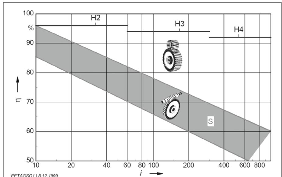
Ориентировочные значения коэффициента полезного действия ( $\eta$ ) для передачи с цилиндрическим косозубым колесом (H) с 2, 3 или 4 ступенями, по сравнению с червячной передачей (S) зависят от передаточного числа ( $i$ ), соотношенного с номинальной мощностью редуктора.
