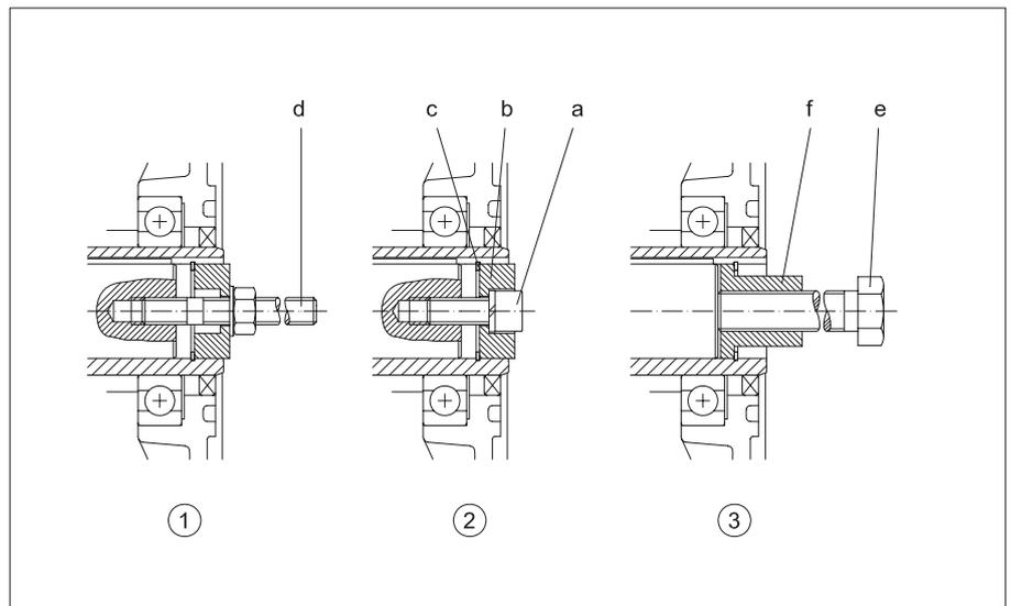
Detaillierte Angaben für Flachgetriebe, Kegelradgetriebe und Schneckengetriebe (siehe Kapitel 11, 12, 13 Maßbilder „Montagehilfe für Flachgetriebe mit Hohlwelle mit Passfedernut“).
