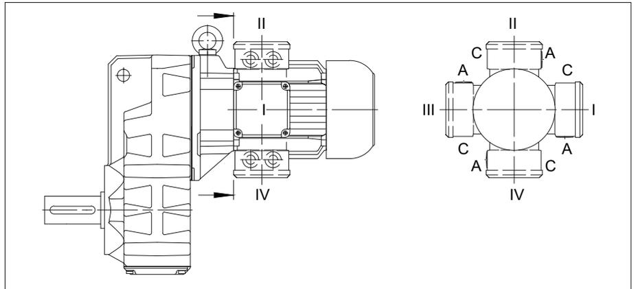
Ein Drehen und Wenden des Getriebemotors im Raum in die verschiedenen Aufstellungen nach DIN 42950 beeinflusst die Bezeichnungshinweise nicht. Die Angabe über die Klemmenkasten Anordnung bezeichnet also stets die Lage des Klemmenkastens und der Leitungszuführung in Bezug auf das Getriebe, nicht auf den Raum. Die Aufstellung nach DIN 42950 ist getrennt anzugeben.
