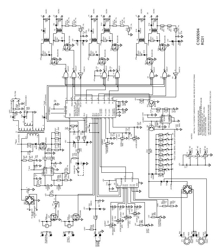
FIGURE 8-4. SCHEMATIC, CONTROL BOARD FOR MODEL SSX0310DTC AND SSX0520DTC CONTROLLERS
