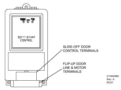
FIGURE 2-4. TERMINAL ACCESS, MODEL SSX0076 CONTROLLERS
