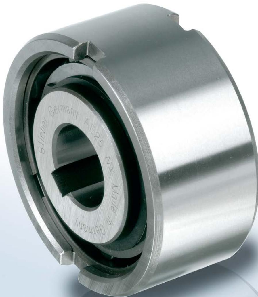
**A**E 是一种无轴承支撑的滚柱式楔块的接触式超越离合器，需要额外提供轴承支撑来承担轴向和径向的负载，而且润滑和密封也需要客户在安装时自行提供。一般AE型超越离合器的外圈直径是和标准深沟球轴承的外圈直径是一致的。其安装的典型组合是：将此型超越离合器与支撑轴承并列布置，共同安装在具有相同孔径和孔公差的箱体轴承座内。下一页有图示。
