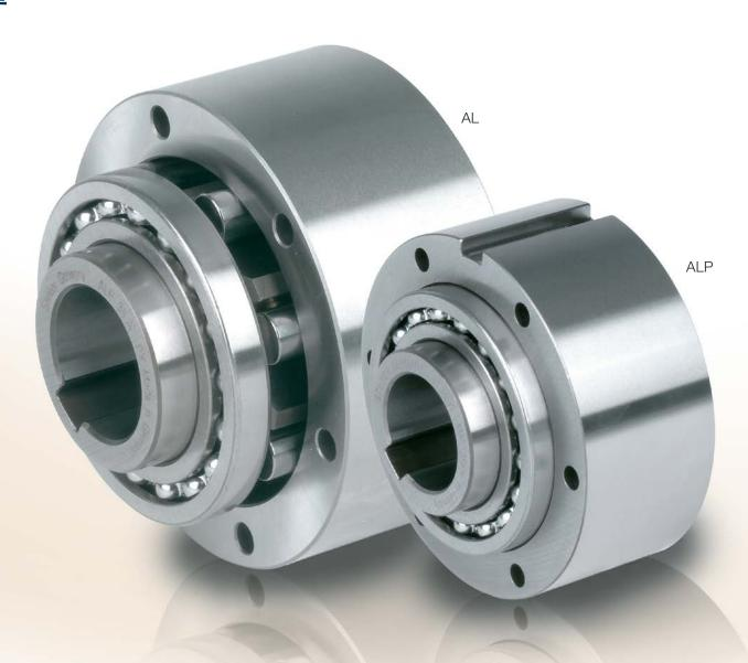
A L 与 ALP 型都是滚柱式楔块接触式超越离合器。这些离合器属于STIEBER模块化系统的组成部分。该型超越离合器两侧采用160系列深沟球轴承作为支撑,使用润滑油润滑。按照设计,这些超越离合器具有独立润滑油润滑和密封功能,其安装的典型组合在后面几页有若干图示。
