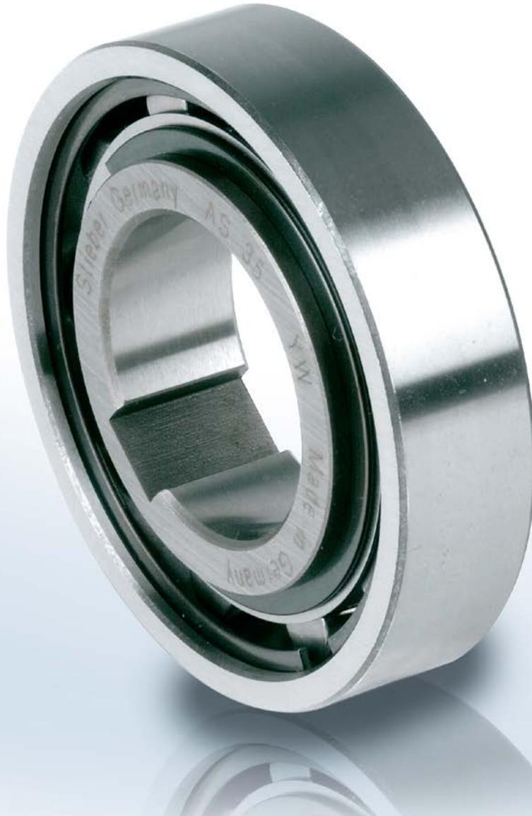
**A**S 型是无轴承支承的滚柱式超越离合器。要承受额外的轴向和径向载荷，需要匹配合适的外部轴承。客户还必须为其提供润滑和密封设计。名义外形尺寸与62系列深沟球轴承尺寸相同。
