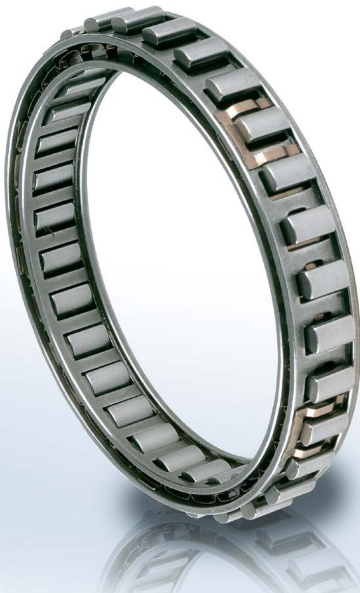
DC 是一种仅带有保持架和楔块总成，无内圈和外圈的接触式超越离合器。在安装时不但需要客户设备提供内圈和外圈，也需要额外提供轴承支撑来承担轴向和径向的负载，而且润滑和密封也需要客户在安装时自行提供。其中DC-N型号可以适用动力传动设备上的各种型号的润滑油。
