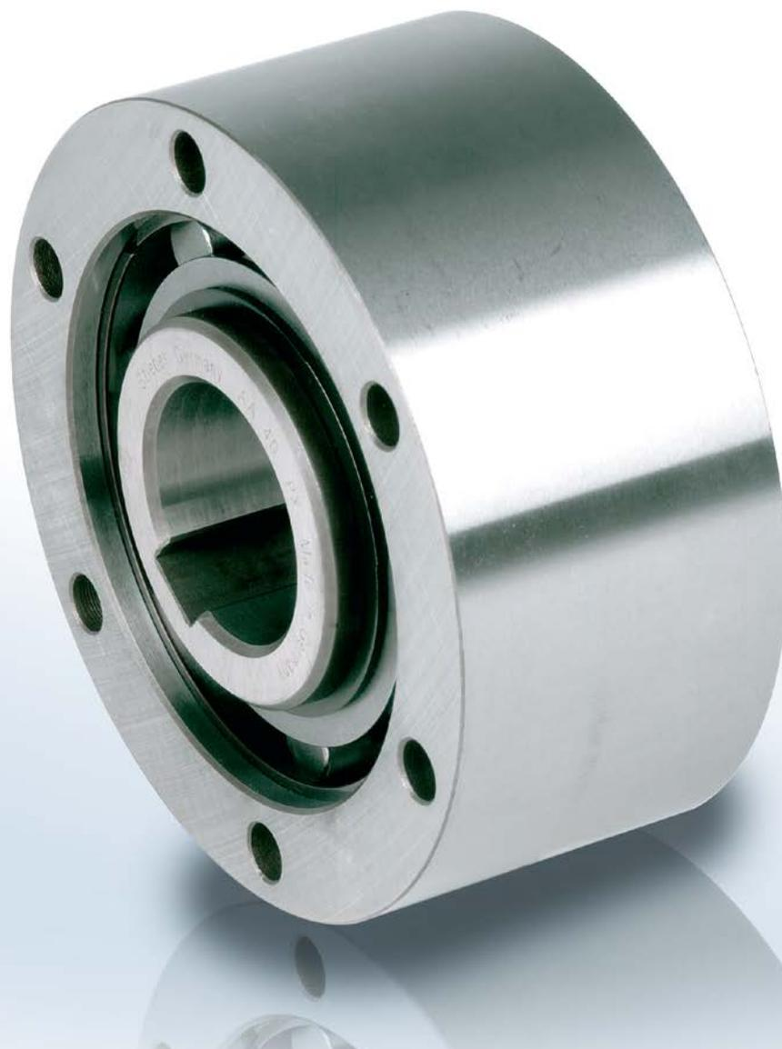
**A** A 是一种无轴承支撑的滚柱式楔块的接触式超越离合器，需要额外提供轴承支撑来承担轴向和径向的负载，而且润滑和密封也需要客户在安装时自行提供。
