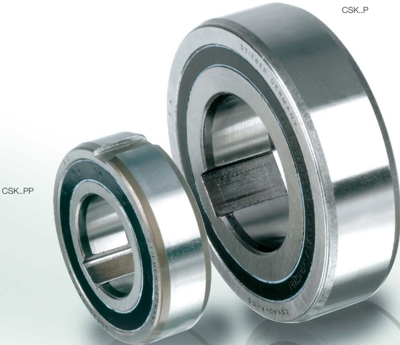
CSK.P 和 CSK..PP型是一种多边形楔块式单向轴承，与62系列深沟球轴承集成在一起（离合器规格40的型号除外）。它由轴承支撑，提供润滑脂润滑，能有效防止超过0.3mm直径的灰尘的进入。特别是当工作温度超过50° C时，建议使用额外的“NYLOS”型密封。该单向轴承使用在油浴润滑的环境里也是允许的。
