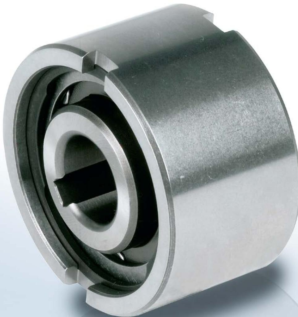
**N**F 型是无轴承支承的滚柱式超越离合器。要承受额外的轴向和径向载荷，需要匹配合适的外部轴承。客户还必须为其提供润滑和密封设计。
