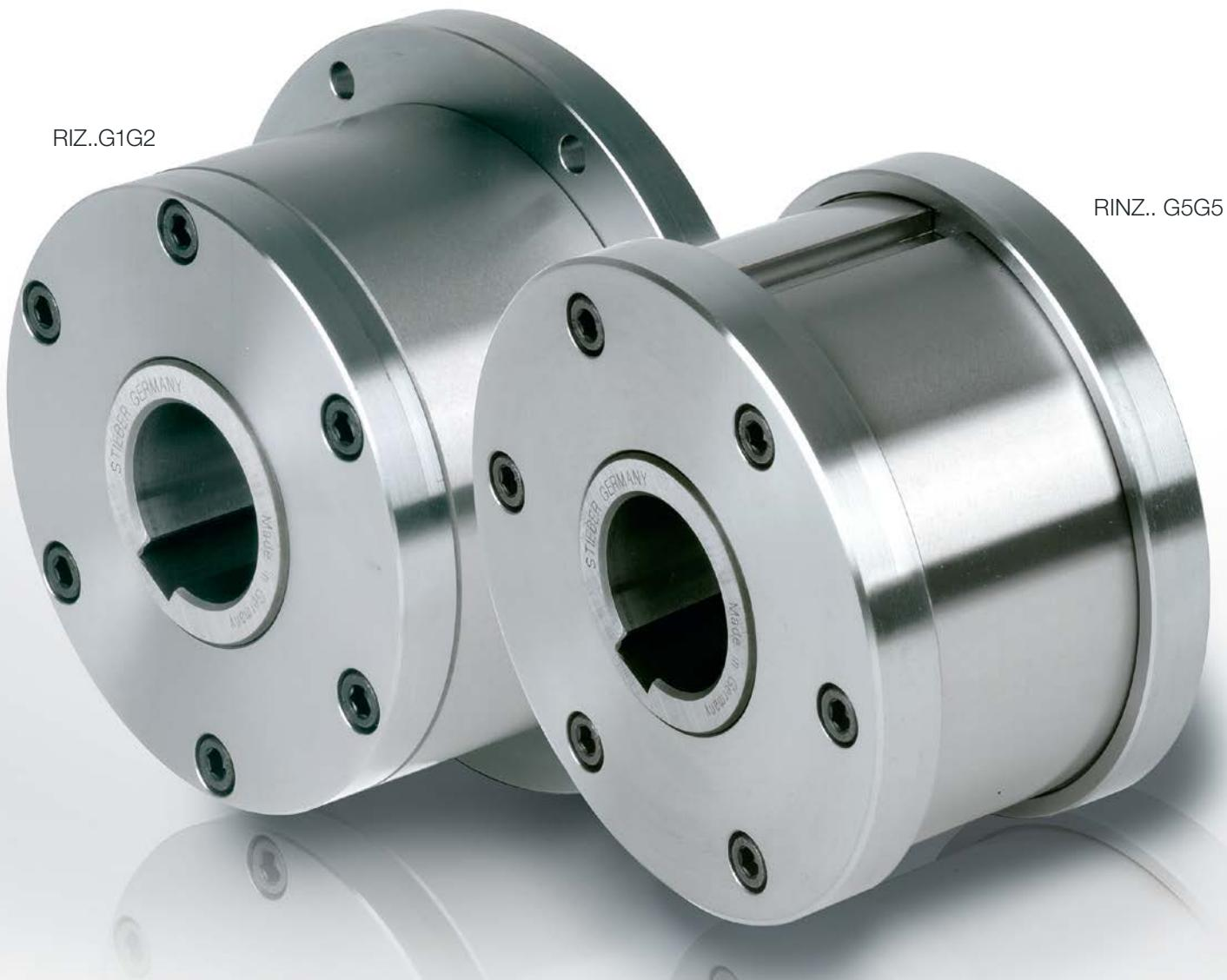
RIZ..G1G2/G7G2 型与 RINZ..G5G5 这些型号也都属于离心楔块式非接触型超越离合器，并且是内圈超越的类型。独立润滑设计，经常作为超越离合器使用。典型的应用是用于超越速度高，但是传递转矩速度低的辅助传动设备。当超越运行时，其超越运转速度必须高于数据表中所列出的最低离心转速；当扭矩传递时，扭矩传递速度必须低于数据表中所列出的允许最高扭矩传递速度。
