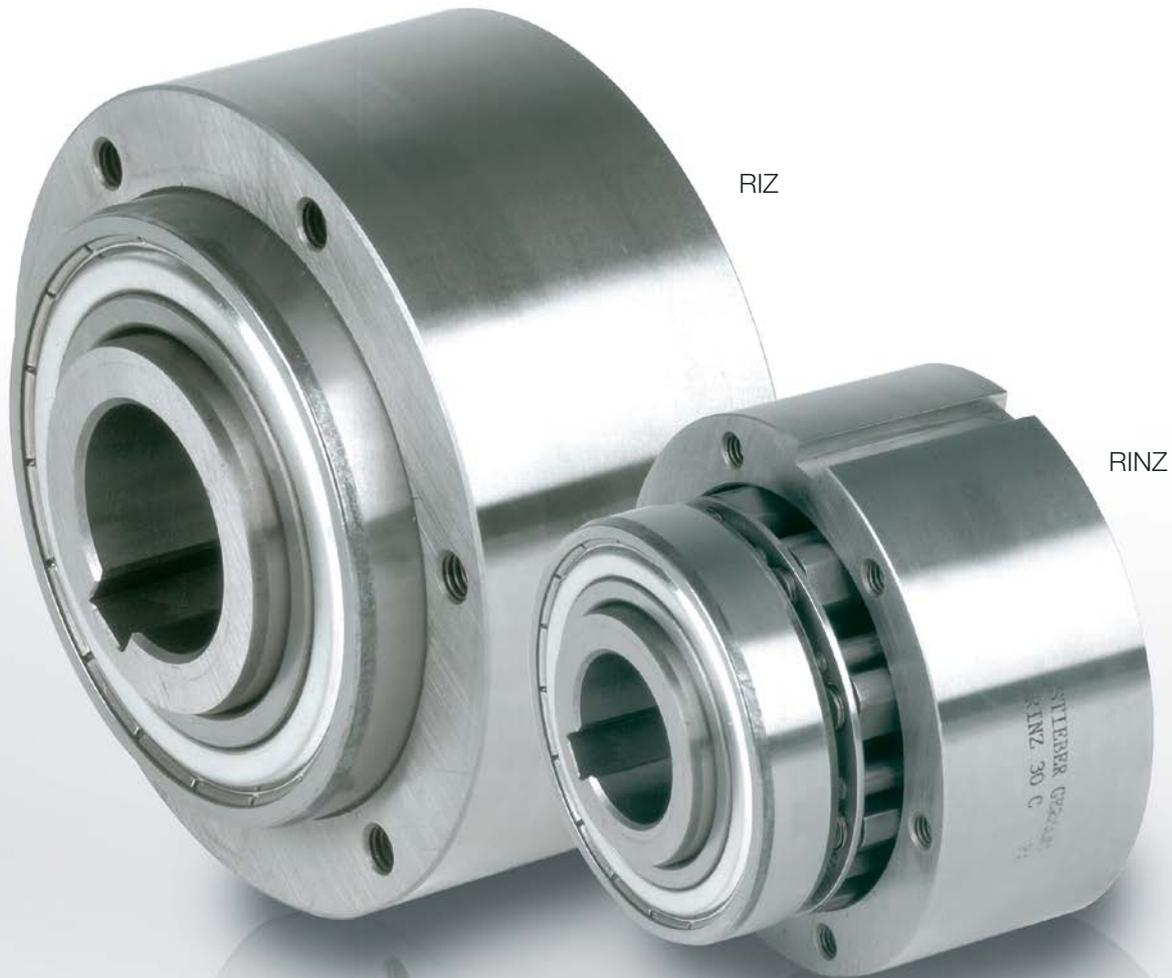
**R**IZ 和 RINZ 这两种型号都属于离心楔块式非接触型超越离合器，并且是内圈超越的类型，适用于逆止功能及超越离合功能的应用。
