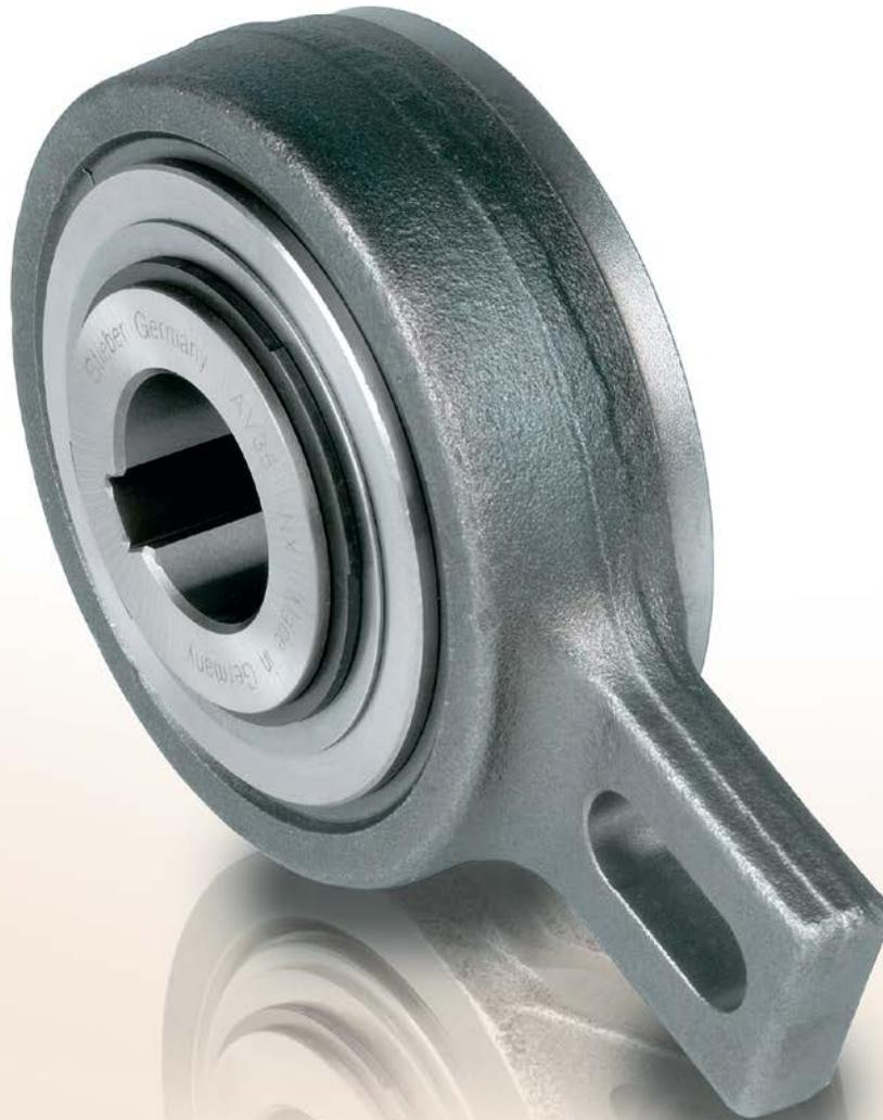
Die Bauart AV ist ein Klemmrollenfreilauf. Er ist gleitgelagert und für niedrige Drehzahlen geeignet. Das Drehmoment ist bei geringem Bauraum sehr hoch. Der Freilauf wird mit Fettschmierung geliefert; die Abdichtung erfolgt mit Labyrinthringen. Er wird montagefertig geliefert für den Einbau in horizontaler oder vertikaler Lage. Diese Bauart wird vornehmlich als Rücklauf Sperre eingesetzt. Sie ist besonders geeignet für die Verwendung unter schwierigen Umgebungseinflüssen (Staub, grober Schmutz).
