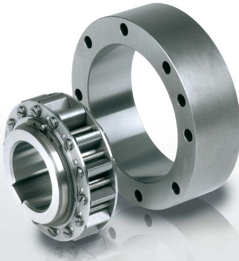
Die Bauart RSCI ist ein fliehkraftabhebender Klemmkörperfreilauf bei drehendem Innenring. Nur dieser Ring ist für die Überholbewegung geeignet. Der Freilauf ist ungelagert. Es müssen Lager vorgesehen werden, welche die Konzentrität der Ringe gewährleisten und Radial- und Axialkräfte aufnehmen. Rund- und Planlauf- fehler müssen innerhalb der angegebenen Toleranzen liegen.
