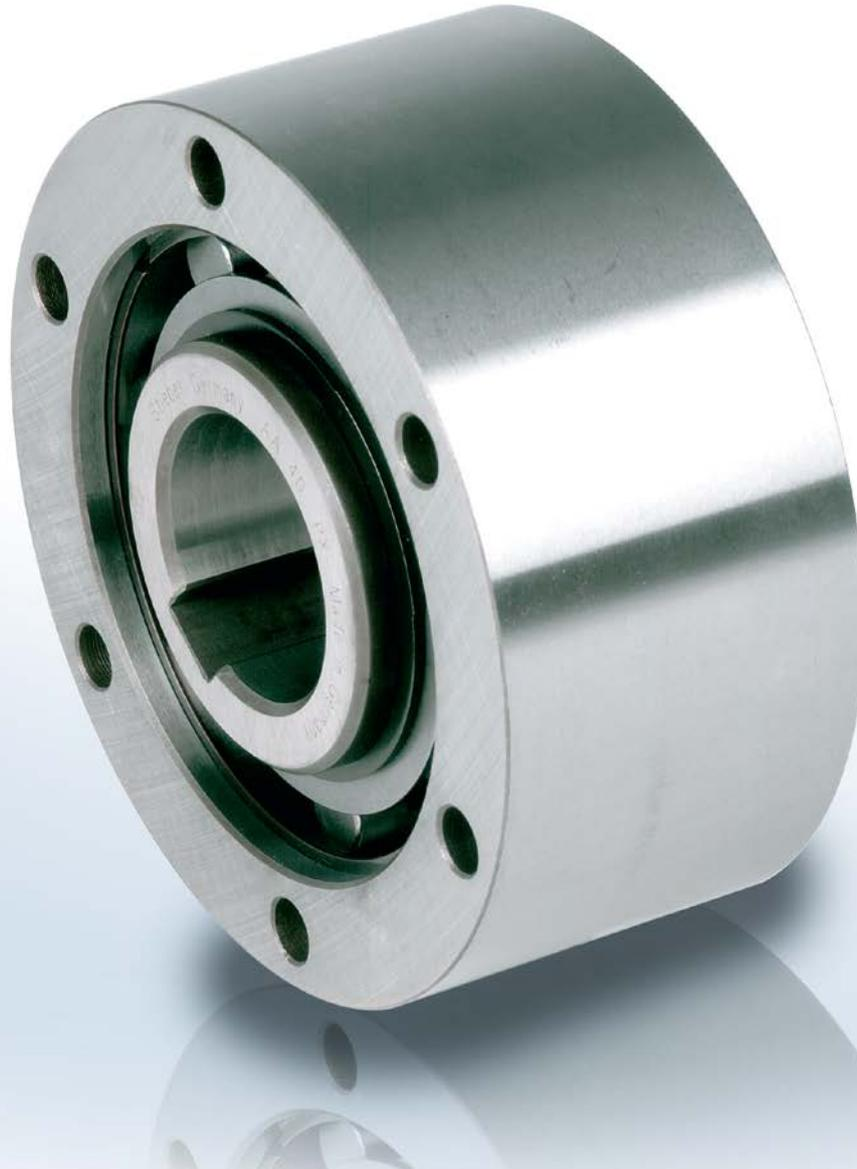
El modelo AA es una rueda libre de tipo rodillo que no se coloca sobre rodamientos. Los rodamientos son necesarios para soportar las cargas axiales y radiales. La lubricación y el sellado también deben proporcionarse en la instalación.
