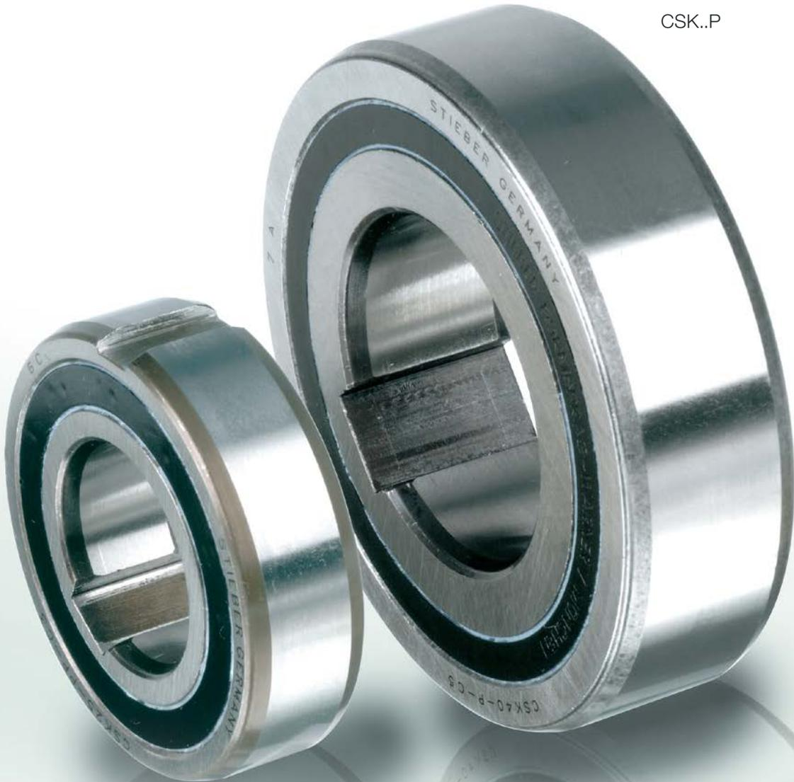
Los modelos CSK..P y CSK..PP son ruedas libres de tipo cuña integradas en rodamientos de bolas de la serie 62.. (excepto el tamaño 40). Se colocan sobre rodamientos, se entregan lubricados con grasa y están protegidos frente al polvo de más de 0,3 mm.
