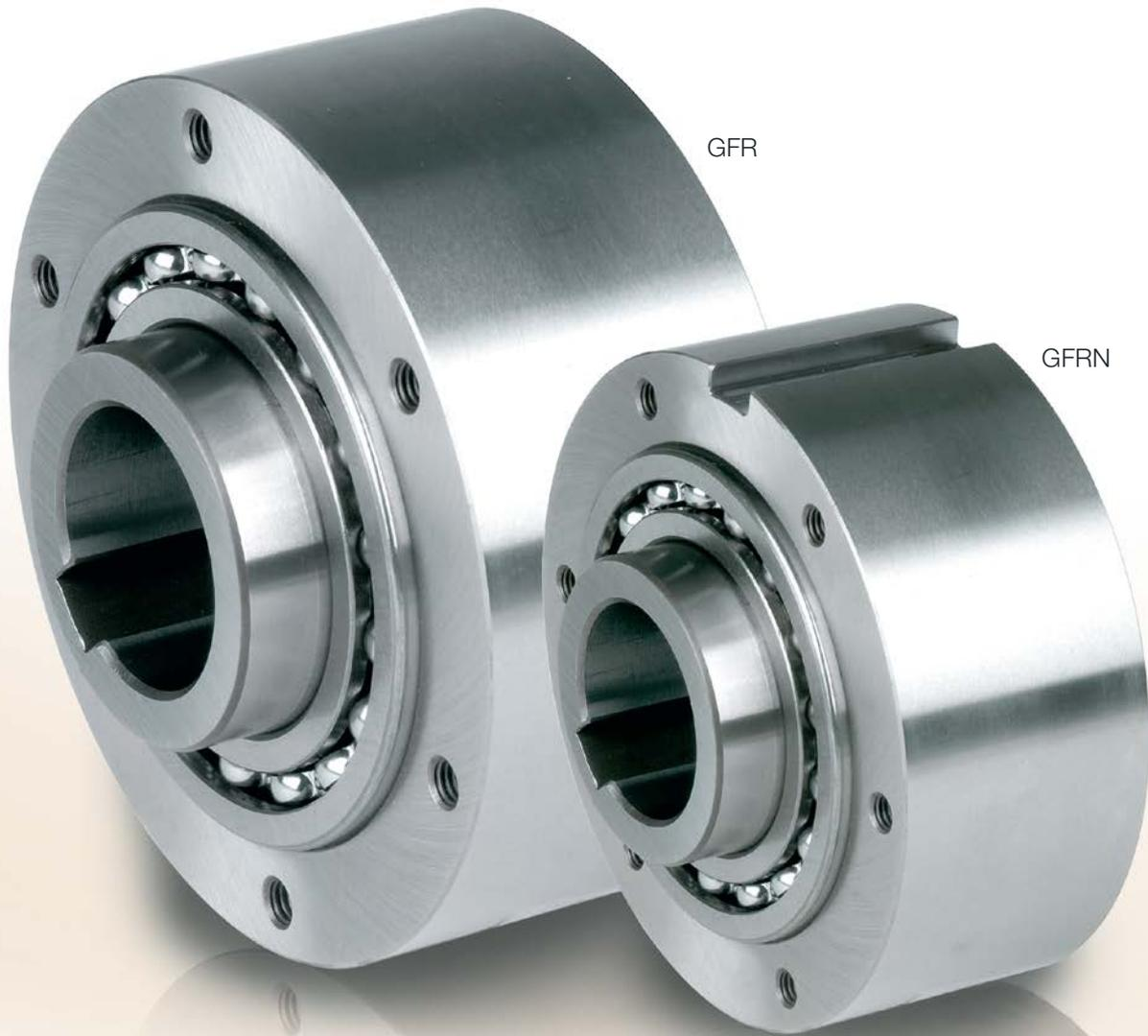
Los modelos GFR y GFRN son ruedas libres de tipo rodillo. Estas unidades forman parte del sistema modular Stieber. Se colocan sobre rodamientos, utilizando dos rodamientos de la serie 160., y requieren lubricación con aceite. Estas unidades pueden utilizarse en diseños que proporcionen lubricación con aceite y sellado, como se muestra en la página siguiente. Los rodamientos no deben someterse a tensión axial.
