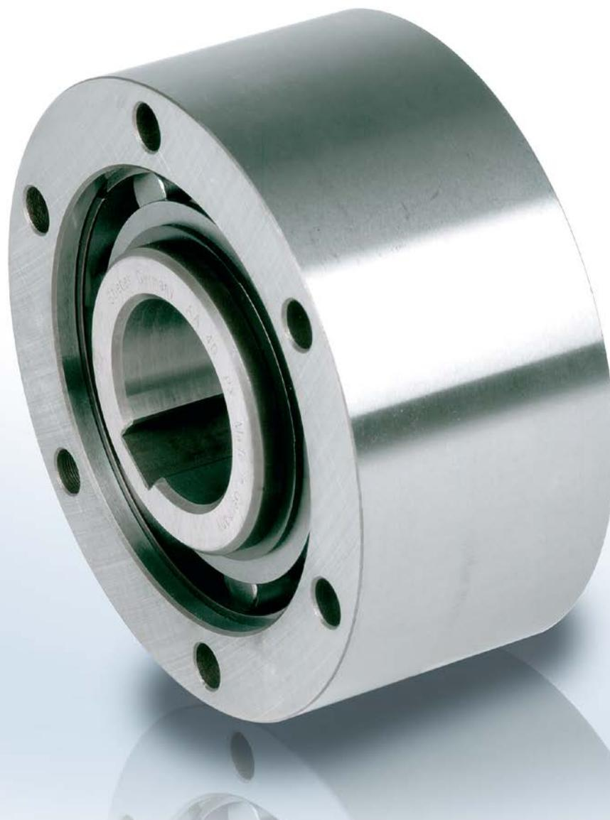
Le modèle AA est une roue libre à rouleaux non auto-centrée. Il est nécessaire de l'intégrer dans un montage fournissant roulements, lubrification et étanchéités.
