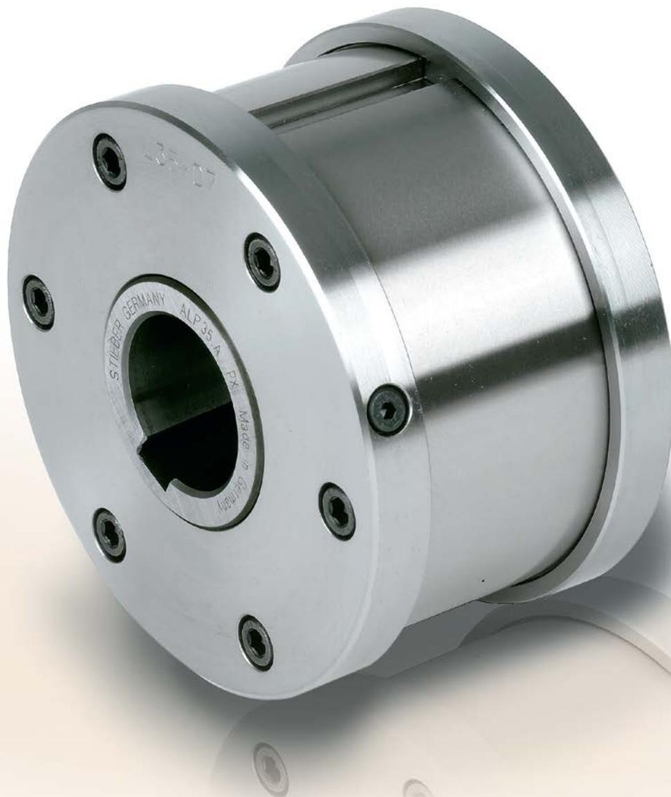
Le modèle ALP..F7D7 est une roue libre à rouleaux, étanche et autonome, autocentrée par deux roulements série 160.. qui n'est pas livrée lubrifiée.
