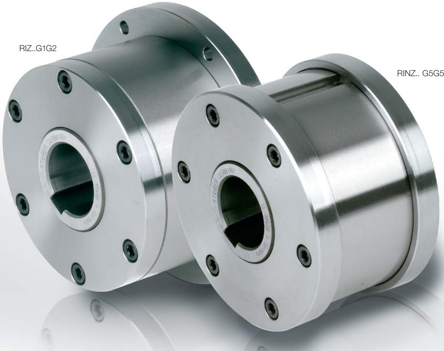
Les modèles RIZ..G1G2/G7G2, RINZ..G5G5 sont des roues libres à cames à dégagement centrifuge par rotation de la bague intérieure qui seule est prévue pour tourner en roue libre.
