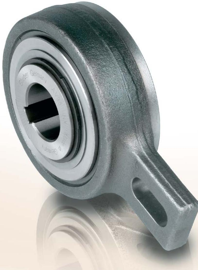
Le modèle AV est une roue libre à rouleaux. C'est une version autonome; centrée par paliers lisses pour des vitesses de rotation faibles. Des joints labyrinthe métalliques assurent l'étanchéité.
