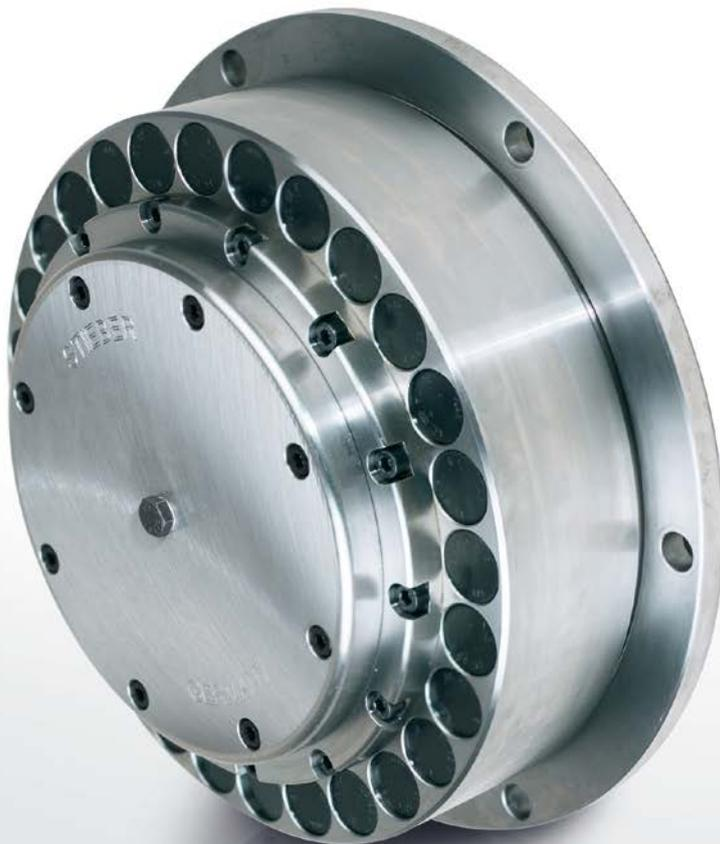
Les modèles RSRV et RSRT sont des antidéviereurs hautes vitesses à dégagement centrifuge des cames équipés en outre d'un système de limitation du couple de retour. Voir le modèle RSCI pages 72 à 75 pour complément d'informations sur cette technologie.
