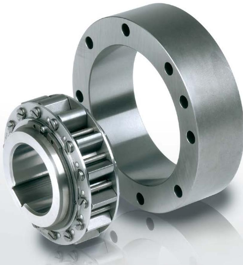
Le modèle RSCI est une roue libre à dégagement centrifuge des cames par rotation de la bague intérieure, qui seule est prévue pour tourner en roue libre. C'est une version non autocentrée.
