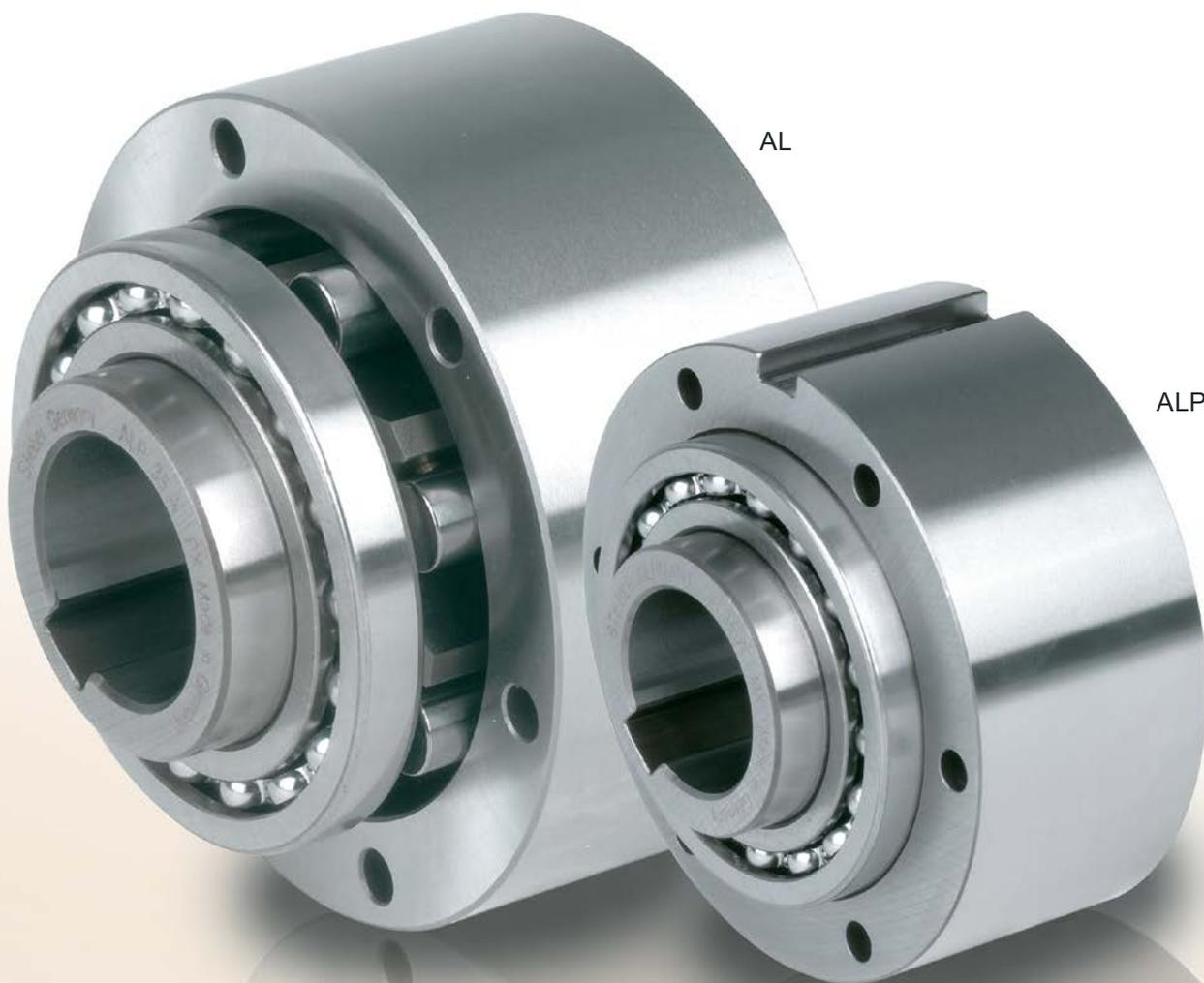
**М**одели AL, ALP представляют собой обгонные муфты роликового типа. Они устанавливаются на два подшипника серии 160, требуют смазки маслом. Эти устройства могут использоваться в конструкциях, предусматривающих смазку маслом и герметизацию, как показано на следующей странице.
