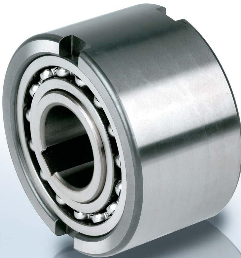
**М**одель NFR представляет собой негерметичную обгонную муфту роликового типа с опорным подшипником. Смазка и герметик наносятся при установке. Смазываются, как правило, маслом.
