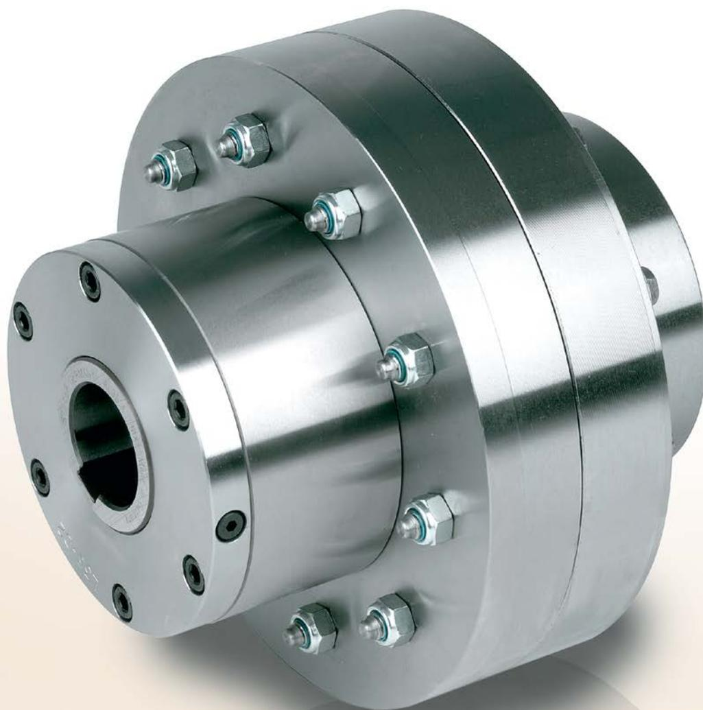
**М**одели AL..KEED2 представляют собой муфты роликового типа, автономные, герметичные, на двух подшипниках серии 160. Поставляются смазанными маслом.
