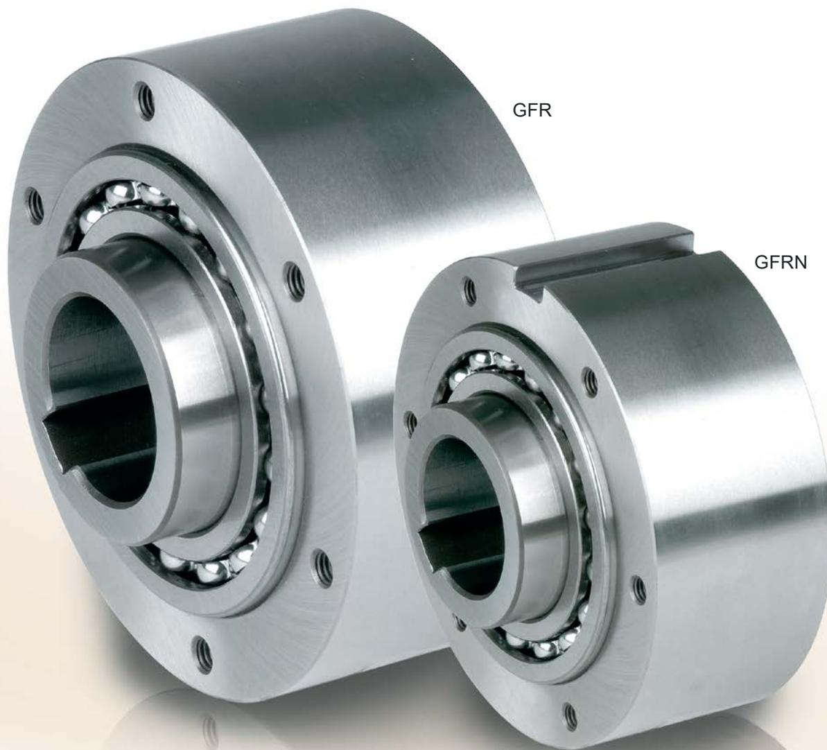
Модели GFR, GFRN представляют собой обгонные муфты роликового типа. Эти устройства являются частью модульной системы Stieber. Их конструкция предусматривает два опорных подшипника серии 160 и требует смазывания маслом. Изделия можно использовать в конструкциях, в которых предусмотрена возможность герметизации и смазки маслом, как в примере на следующей странице. Подшипники не должны подвергаться осевой нагрузке.
