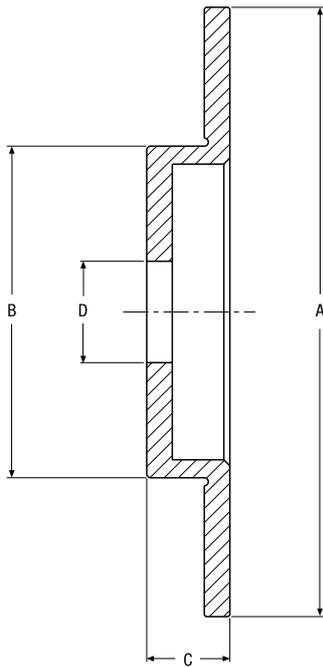
Alle Twiflex Bremsscheiben können den Kundenanforderungen entsprechend fertigbearbeitet werden. Scheibengrößen, die nicht in den obigen Tabellen aufgeführt werden, können auf Bestellung geliefert werden. Bremsscheiben werden aus Sphäroguss hergestellt.
