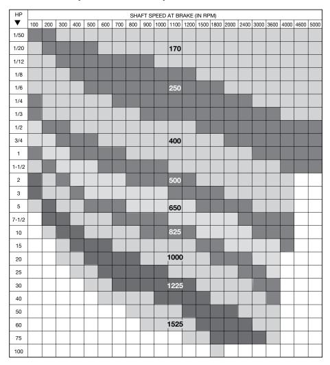
IF THERE IS A CHOICE OF LOCATIONS FOR THE CLUTCH OR BRAKE SELECT THE HIGHEST SPEED SHAFT. THE HIGHER THE SPEED – THE SMALLER THE CLUTCH OR BRAKE REQUIRED.
