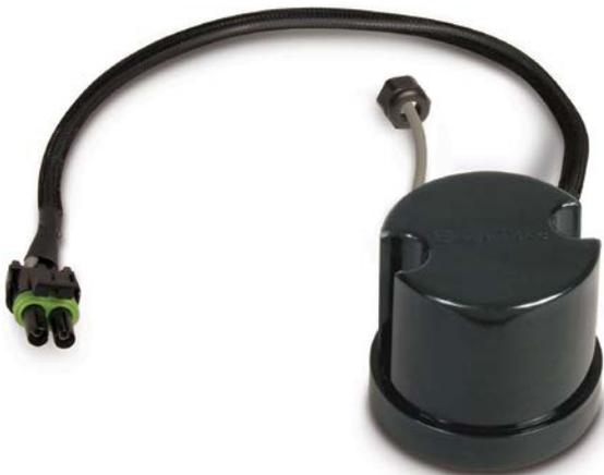
Le PQS est un système limiteur de courant bidirectionnel. Le contrôle surveille le courant pendant le mouvement du vérin et l'arrête immédiatement si un objet se met en travers de son chemin ou en fin de course. Le vérin reste coupé jusqu'au retour de l'alimentation. Les paramètres de limites de courant sont réglables à l'aide de deux potentiomètres accessibles par deux orifices protégés sur le côté du boîtier.
