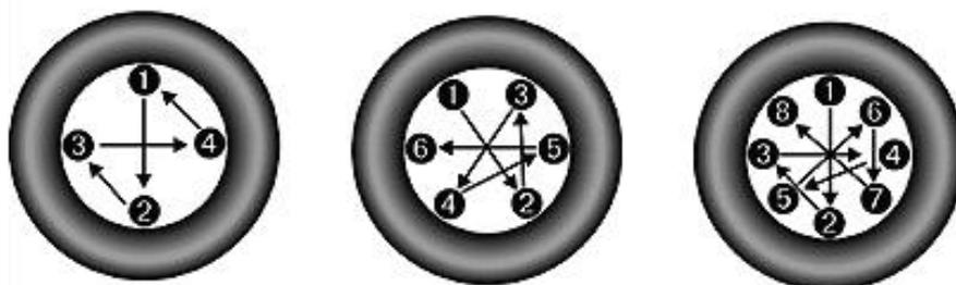
*Inserir os parafusos e realizar o torqueamento em cruz de acordo com o modelo acima.*
