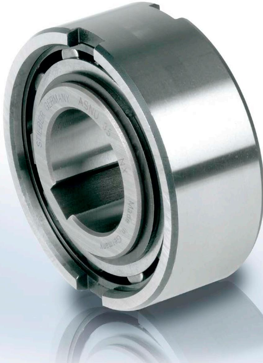
ASNU 型是无轴承支承的滚柱式超越离合器。要承受额外的轴向和径向载荷，需要匹配合适的外部轴承。客户还必须为其提供润滑和密封设计。名义外形尺寸与63系列深沟球轴承尺寸相同。
