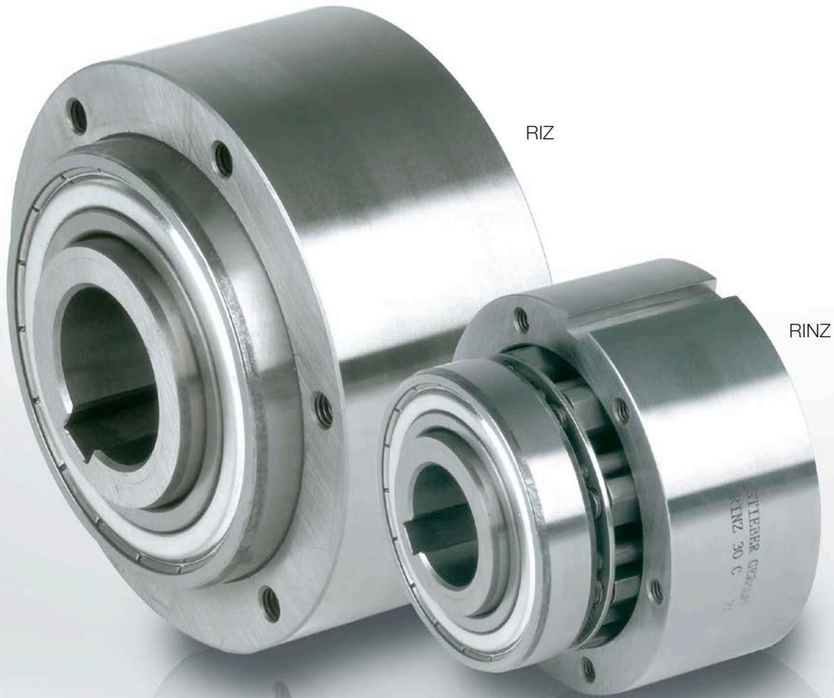
RIZ 和 RINZ 这两种型号均为带离心非接触模块的超越离合器，一般使用在内圈超越旋转的设计中，且只适用于内圈超越旋转，也常用于逆止器的应用。
