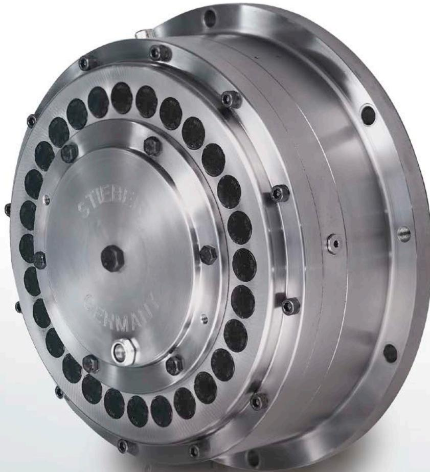
Die Bauart RDBK basiert auf dem fliehkraftabhebenden Freilauf RSCI (siehe Seite 72 bis 75), welcher zusätzlich mit einer kraftschlüssigen Drehmomentbegrenzung ausgestattet ist. Das maximal zu übertragende Drehmoment wird werksseitig nach Kundenwunsch eingestellt.
