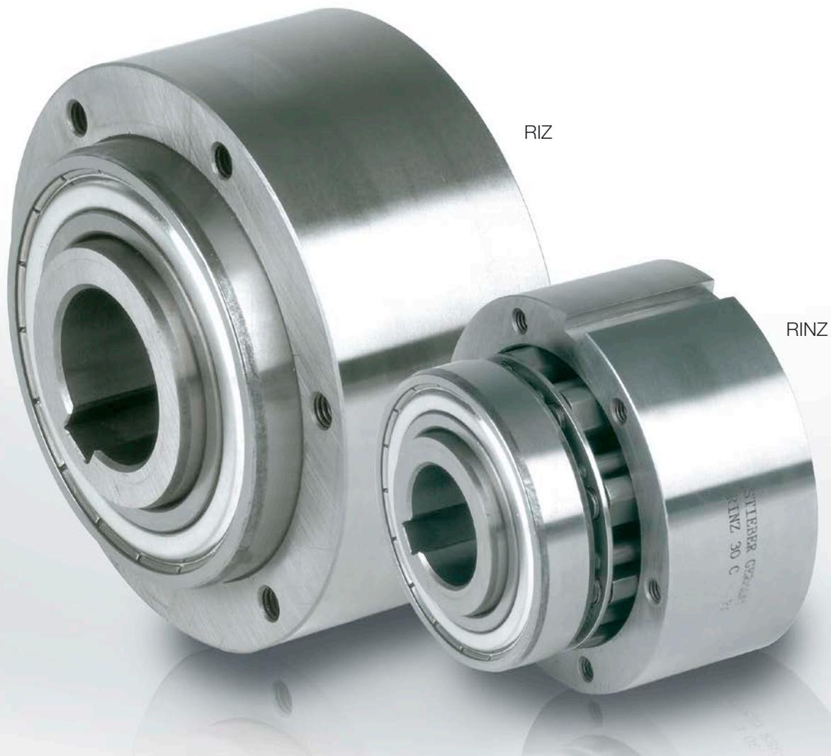
Los modelos RIZ y RINZ son ruedas libres de tipo cuña de elevación por fuerza centrífuga, con rotación de la pista interna. Adecuados para aplicaciones de embrague de rueda libre o antirretorno. Solo la pista interna se ha diseñado para rodar a rueda libre.
