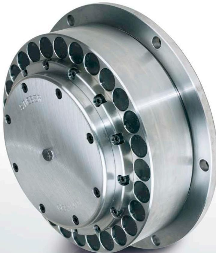
Модели RSRV и RSRT представляют собой высокоскоростные муфты с подъемом кулачков под действием центробежной силы и с ограничителем крутящего момента. Дополнительные сведения по стопорам обратного хода производства Stieber с подъемом кулачков от центробежной силы см. на с. 72–75 каталога RSCI.
