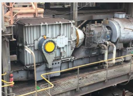
**Problem:** Für ein Förderband, welches Kohle aus einem Tagebau in ein nahegelegenes Kraftwerk liefert, benötigte ein bedeutendes australisches Unternehmen Ersatz für mehrere langsam laufende Rücklaufsperrn. Die existierenden Rücklaufsperrn mussten alle zwei Jahre sehr aufwendig ausgebaut und überholt werden.
