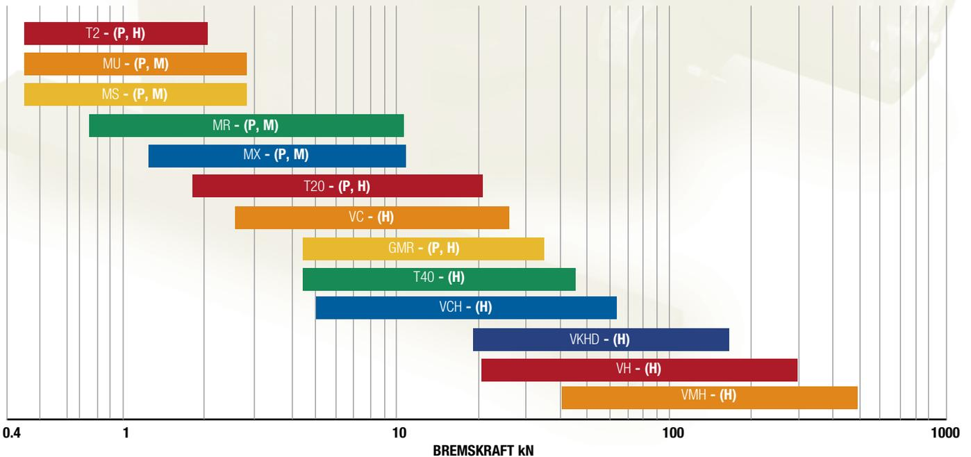
\*Es sollte beachtet werden, dass die gezeigten Bremskräfte nur für eine einzige Bremszange gedacht sind und häufig mehrere Bremszangen an einer Scheibe eingesetzt werden, wobei der verfügbare Platz die gewöhnliche Limitierung ist.
