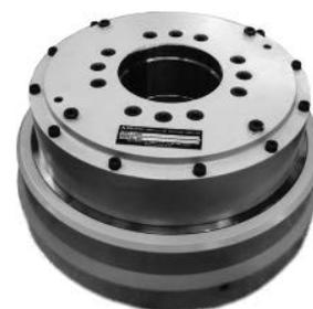
Муфты модели НС(D) оснащены внешним шлицевым ведущим кольцом под болтовое соединение с ведущим или ведомым элементом заказчика. Также муфты могут поставляться без внешнего приводного кольца, чтобы предоставить заказчику возможность выполнить шлицы для внешнего привода внутри элемента его собственного производства. Данная возможность полезна в случаях, когда требуется минимальное осевое расстояние, поскольку можно разместить муфту внутри ведущего или ведомого элемента заказчика.
