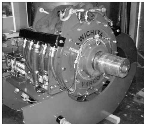
Тормоза Wichita CSM создают точную нагрузку на долото для точного управления буровой лебедкой.
