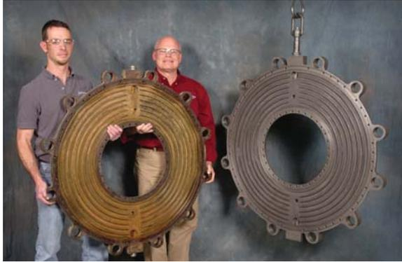
36 英寸的新型水套 (左) 大约仅重95 磅。相比之下, 36 英寸的铸铁水套 (右) 则重约375 磅。设备重量的减轻对于设备的维护保养具有重要的意义, 尤其是对于设备安装有重量限制的应用领域, 例如用于林业操作的集材绞盘机。
