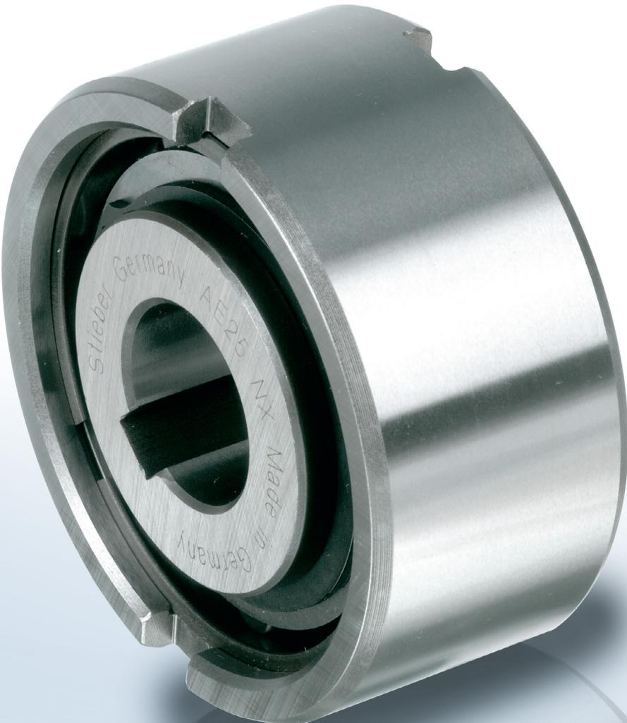
AA 是一种无轴承支撑的滚柱式楔块的接触式超越离合器，需要额外提供轴承支撑来承担轴向和径向的负载，而且润滑和密封也需要客户在安装时自行提供。
