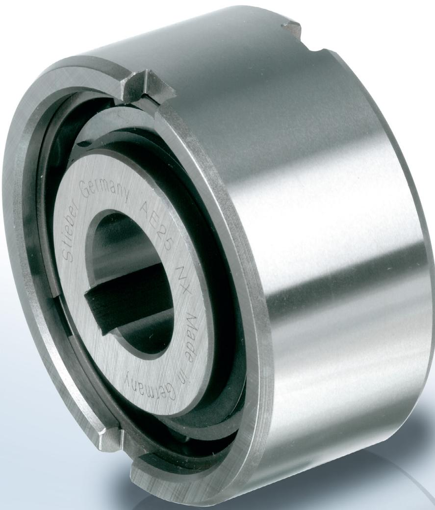
AE 是一种无轴承支撑的滚柱式楔块的接触式超越离合器，需要额外提供轴承支撑来承担轴向和径向的负载，而且润滑和密封也需要客户在安装时自行提供。一般AE型超越离合器的外圈直径是和标准深沟球轴承的外圈直径是一致的。
