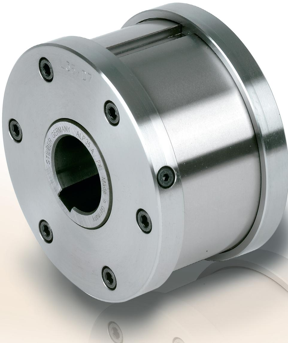
ALP..F7D7 和ALMP..F7D7型都是滚柱式楔块接触式超越离合器, 该型超越离合器两侧采用160系列深沟球轴承作为支撑, 有独立的润滑和密封设计, 并使用润滑油润滑。(出厂时不加注润滑油)
