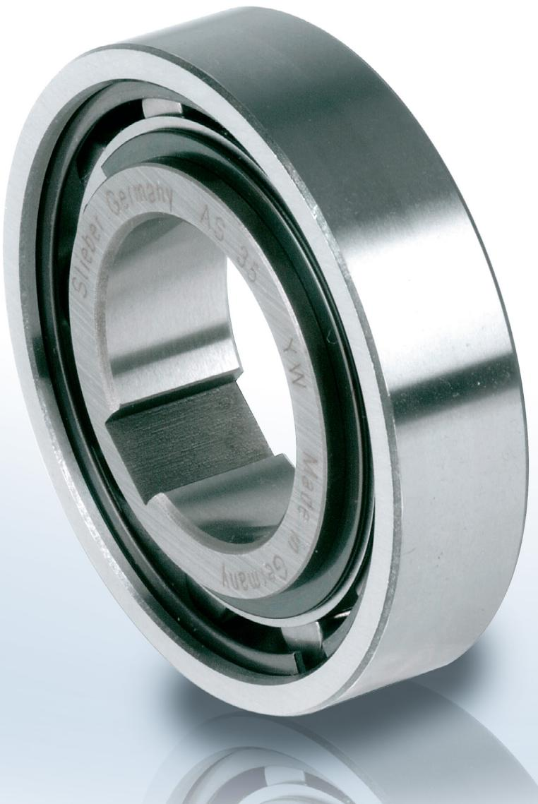
AS型是无轴承支承的滚柱式超越离合器。要承受额外的轴向和径向载荷,需要匹配合适的外部轴承。客户还必须为其提供润滑和密封设计。名义外形尺寸与62系列深沟球轴承尺寸相同。
