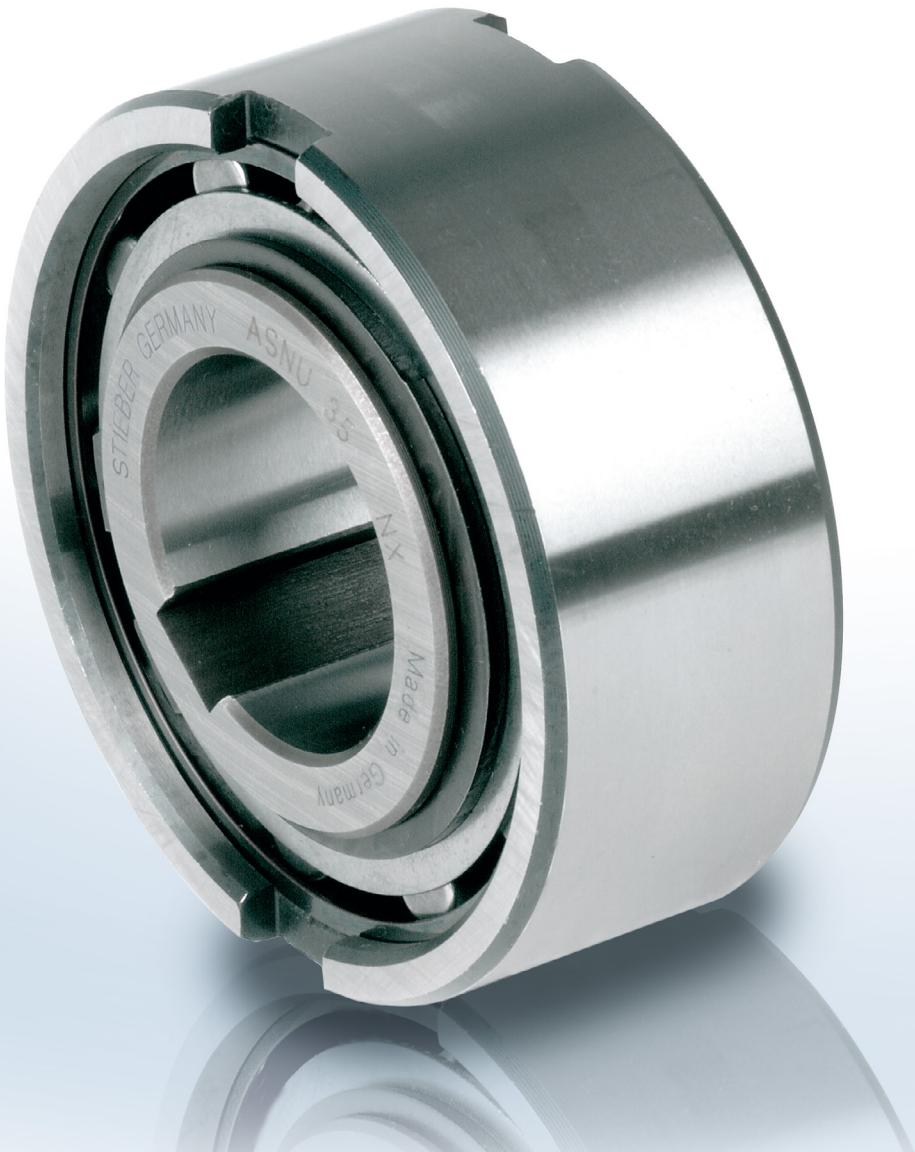
ASNU 型是无轴承支承的滚柱式超越离合器。要承受额外的轴向和径向载荷, 需要匹配合适的外部轴承。客户还必须为其提供润滑和密封设计。名义外形尺寸与63系列深沟球轴承尺寸相同。
