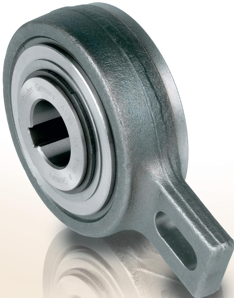
AV 是一种滚柱式楔块接触式超越离合器。它具有独立润滑结构，其楔块由两侧的滑动轴承定位，适用于低速应用，并且使用被防护罩保护的金属迷宫密封进行密封。
