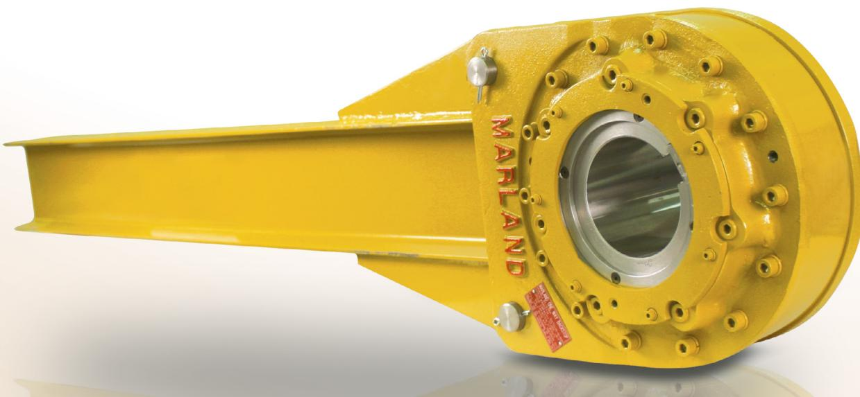
BC MA型是一种滚柱式逆止器，楔块两侧有轴承支承，独立式润滑。标准润滑方式是油润滑。
