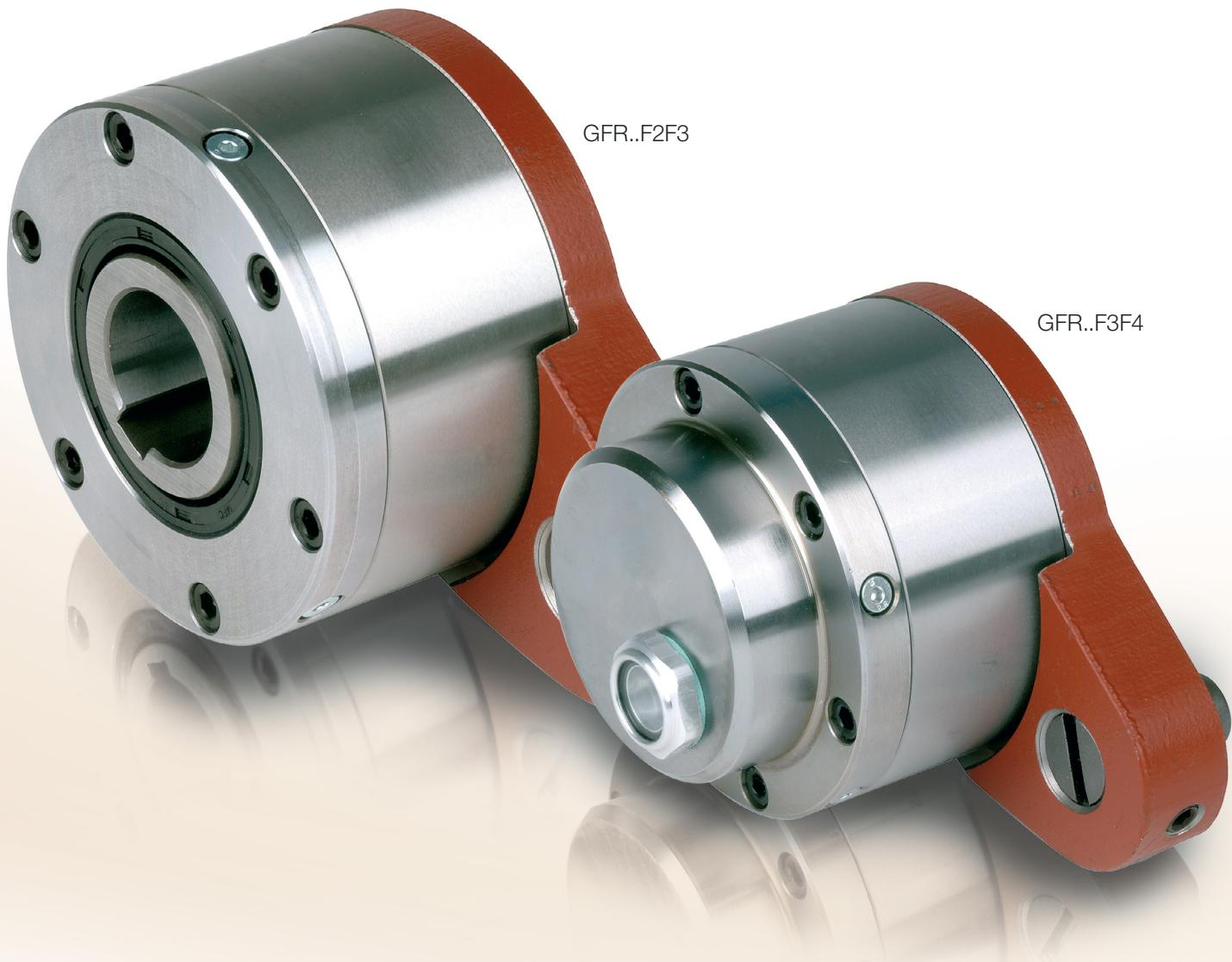
GFR..F2F3/F3F4 型都是滚柱式楔块接触式超越离合器, 该型超越离合器两侧采用160系列深沟球轴承作为支撑, 有独立的润滑和密封设计, 并使用润滑油润滑。
