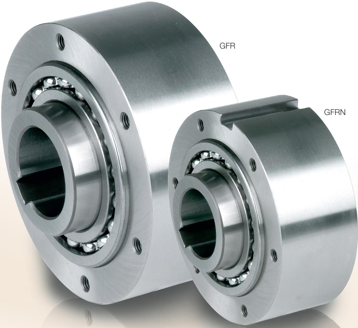
GFR 与 GFRN 型都是滚柱式楔块接触式超越离合器。这些离合器属于STIEBER模块化系统的组成部分。该型超越离合器两侧采用160系列深沟球轴承作为支撑, 使用润滑油润滑。按照设计, 这些超越离合器具有独立润滑油润滑和密封功能, 其安装的典型组合在后面几页有若干图示。
