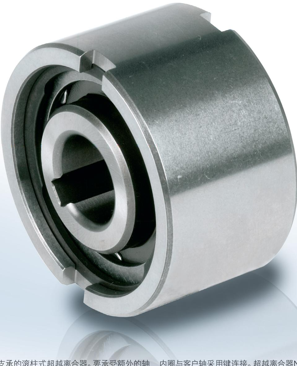
NF型是无轴承支承的滚柱式超越离合器。要承受额外的轴向和径向载荷, 需要匹配合适的外部轴承。客户还必须为其提供润滑和密封设计。
