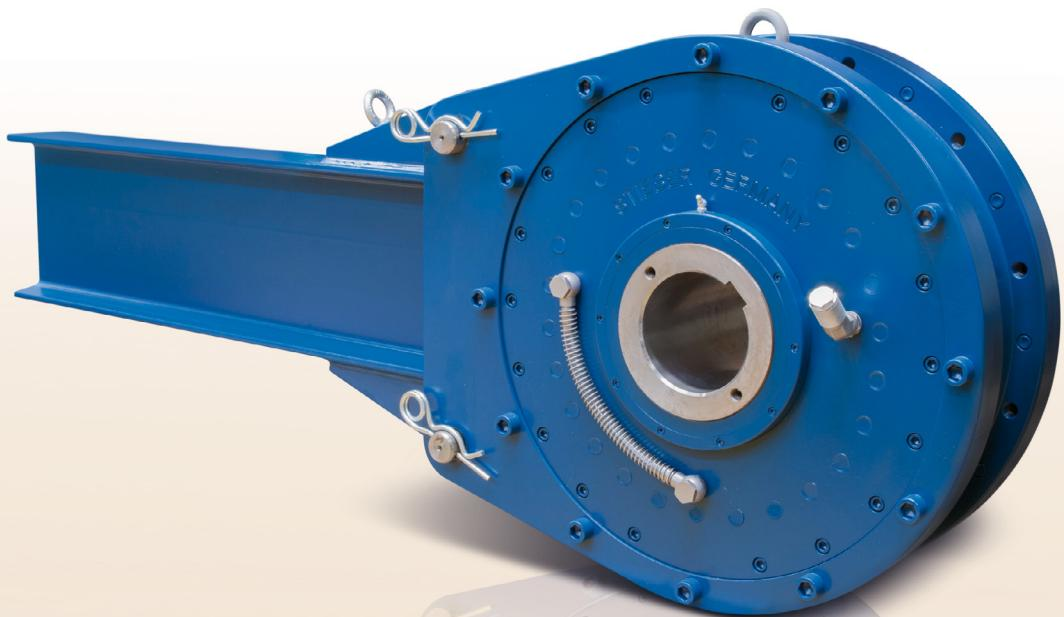
RDBR-E型逆止器可以直接安装在设备的驱动轴上, 比如重型输送皮带机, 搅拌筒驱动和重型链式输送设备, 而这些设备往往需要力矩限制, 负载均分或者手动/自动释放等各种功能。
