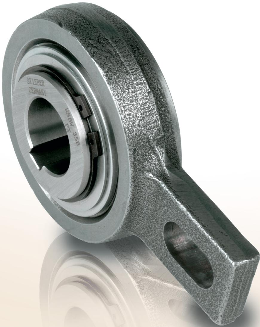
RSBW型超越离合器具有和DC系列相同的保持架和楔块总成，属于接触式超越离合器。它具有独立润滑结构，其楔块由两侧的滑动轴承定位，适用于低速应用，并且使用被防护罩保护的O型圈进行密封。
